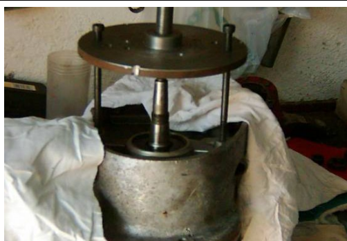
Obr. 159. Vytlačení klikového mechanismu z levé poloviny skříně
