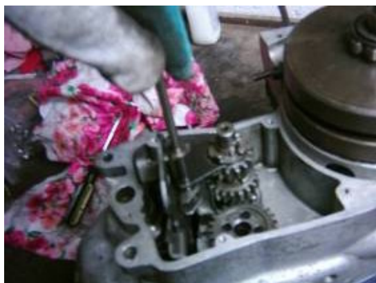
Obr. 180. Vodící tyčka vložena
