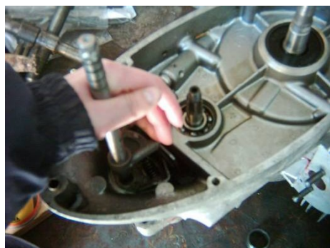
Obr. 191. Vkládání hřídele s unášечem
