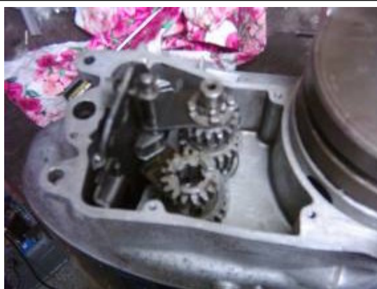
Obr. 182. Předlohové kolo II vloženo
