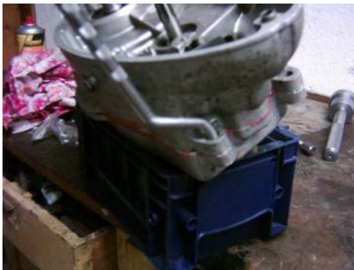
Obr. 150. Vyrázení středícího pouzdra pomocí přípravku
