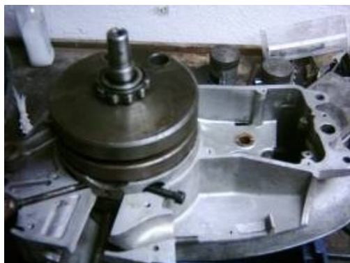
Obr. 158. Levá polovina motoru po oddělení a vyjmutí převodovky
