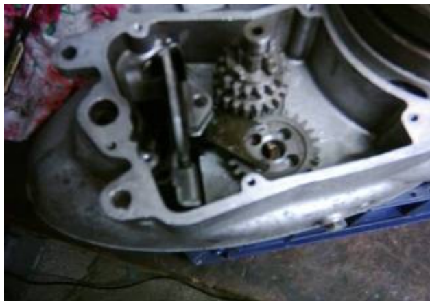
Obr. 178. Řadicí vidlice vložena do kulisy
