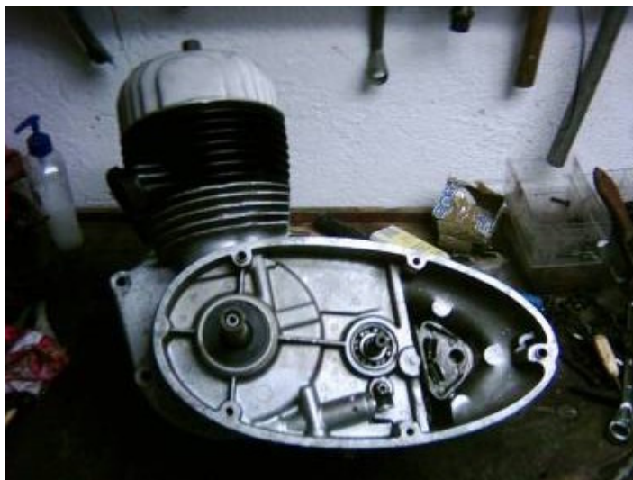
Obr. 147. Demontovaná levá strana motoru
