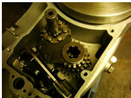
Obr. 183. Předlohové kolo III na horní vidlici
