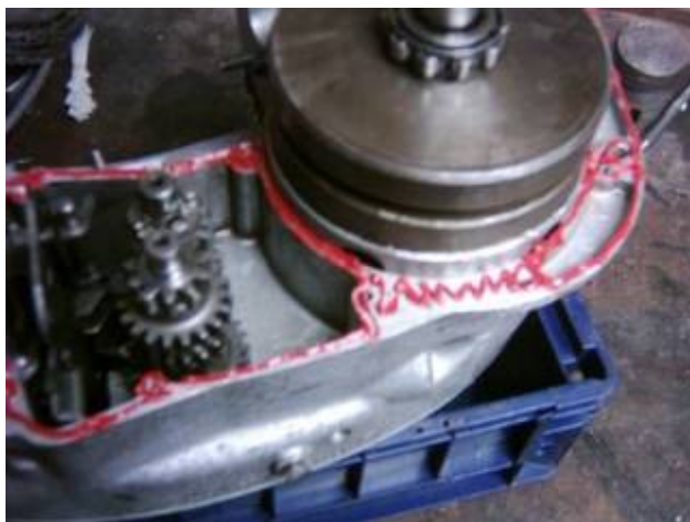
Obr. 185. Vložení klikového mechanismu a nanesení těsnění
