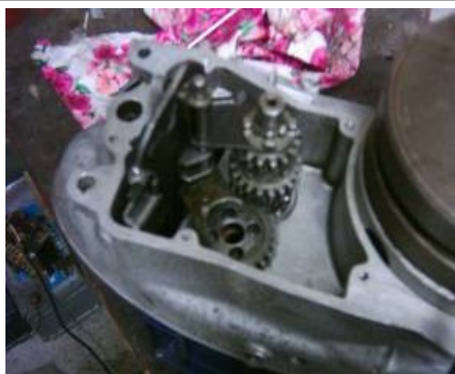
Obr. 179. Horní řadicí vidlice vložena
