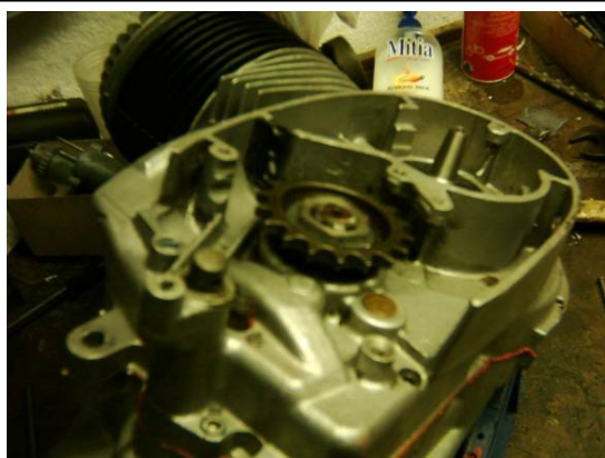
Obr. 193. Montáž řetězového kolečka sekundárního převodu
