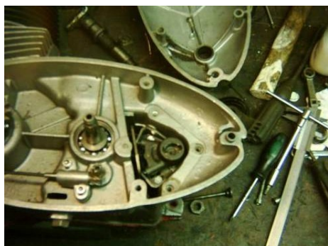
Obr. 192. Doražení hřídele s unášečem
