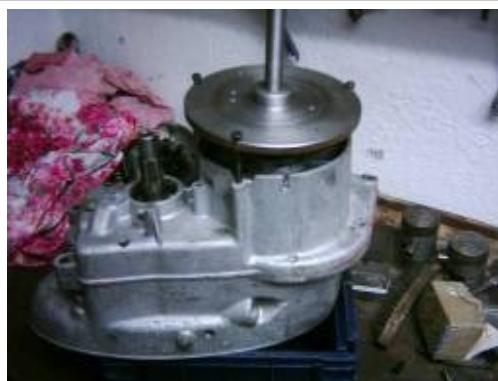
Obr. 157 Nasazení stahováku a rozpůlení skříně
