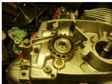
Obr. 168. Demontáž řetězového kolečka sekundárního převodu
