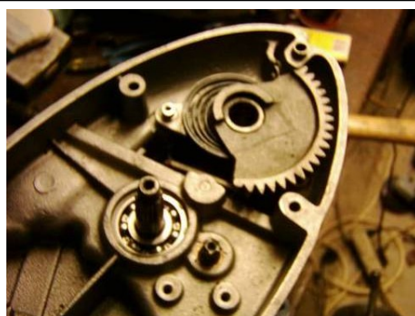
Obr. 163. Vyrážení hlavního hřídele
