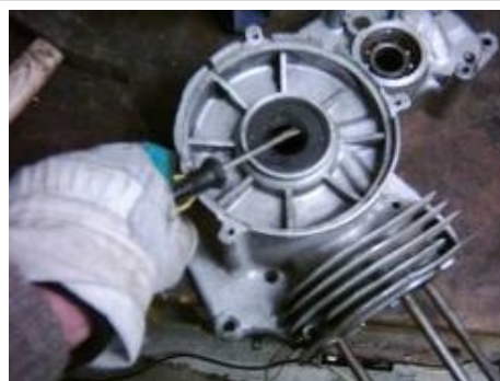
Obr. 166. Vypáčení těsnicího kroužku
